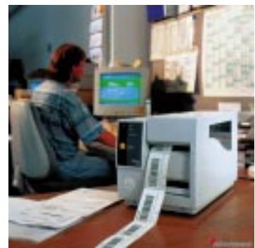
Erzeugung des ersten Barcode-Labels im Wareneingang mit dem Intermec-Drucker 3400.
